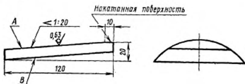
Непараллельность поверхностей *A* и *B* не допускается более 0,05 мм на длине образца.
