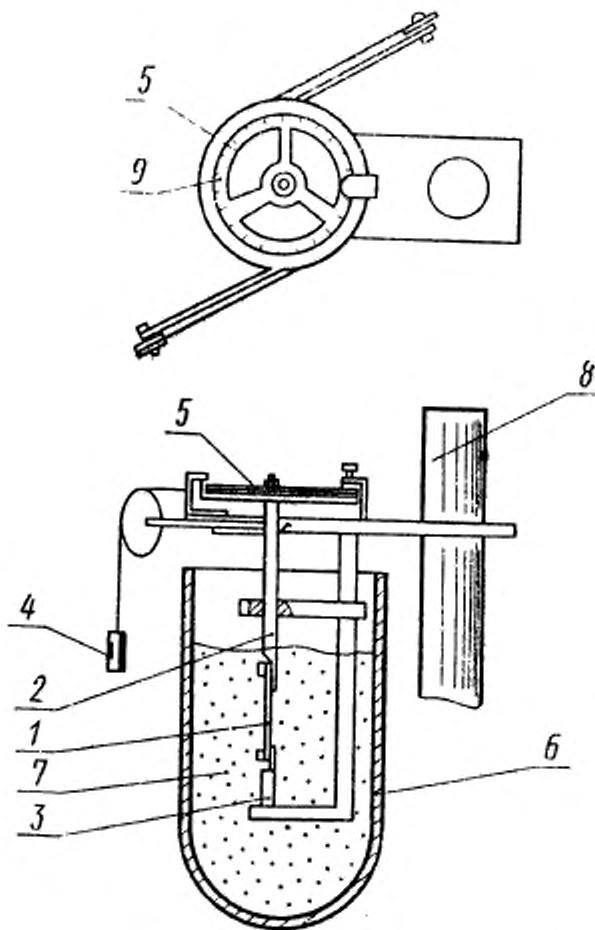
1—образец; 2, 3—зажимы; 4—груз; 5—шкала в градусах; 6—сосуд Дьюара; 7—охлаждающая смесь; 8—опорная стойка; 9—стрелка.
