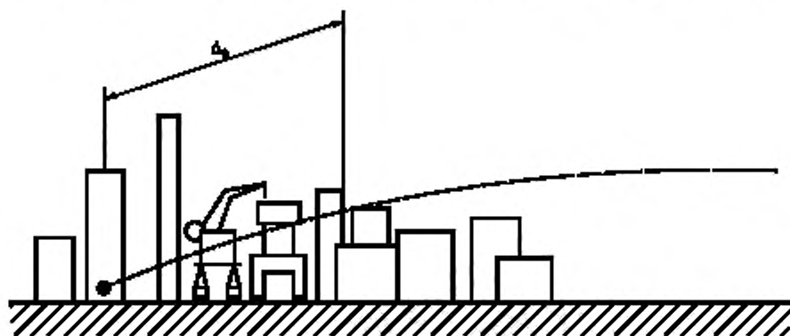
Рисунок А.2 — Затухание пропорционально длине d_s при распространении звука в промышленной зоне с оборудованием
