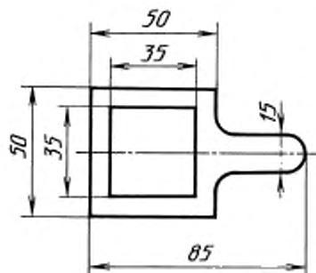
3.2. Внешний вид смазки определяют на пластинке размером 50×70×2 мм из стекла по ГОСТ 111—90. Смазку наносят с помощью металлического шаблона, не подвергающегося коррозии.
