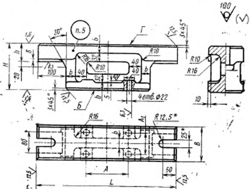
\* Окончательный размер устанавливается по ширине паза ползуна пресса.
