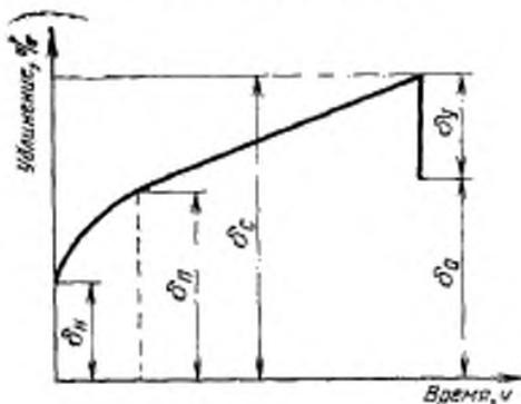
δ<sub>н</sub>—удлинение при нагрузке; δ<sub>п</sub>—полное (упругое + остаточное удлинение на криволинейном участке); δ<sub>с</sub>—суммарное (упругое + остаточное) удлинение за время испытания; δ<sub>у</sub>—упругое удлинение; δ<sub>о</sub>—остаточное удлинение
