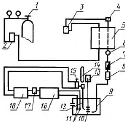
Примечание. Вместо бюретки 14, магнитного клапана 15 можно использовать автоматическую бюретку — дозатор Б-701. Электролитическую ячейку 9 вместимостью 200 см<sup>3</sup> можно заменить сосудом с пористым фильтром № 2 или 3 вместимостью 100 см<sup>3</sup>.
