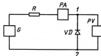
*G* — генератор постоянного или пульсирующего напряжения; *R* — резистор; *PA* — измеритель тока; *VD* — испытуемый диод; *PV* — измеритель напряжения
