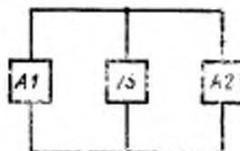
AI—устройство задания электрического режима в цепи основных выводов тиристора; VS—испытуемый тиристор; A2—измерительное устройство для измерения напряжения переключения
