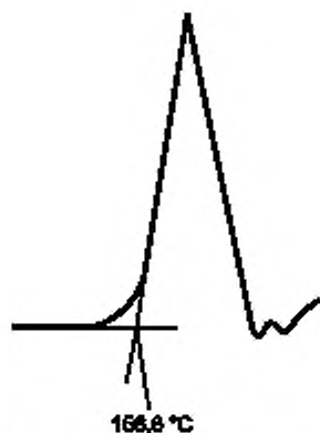
Рисунок В.1 — Типичная эндотерма плавления индия
