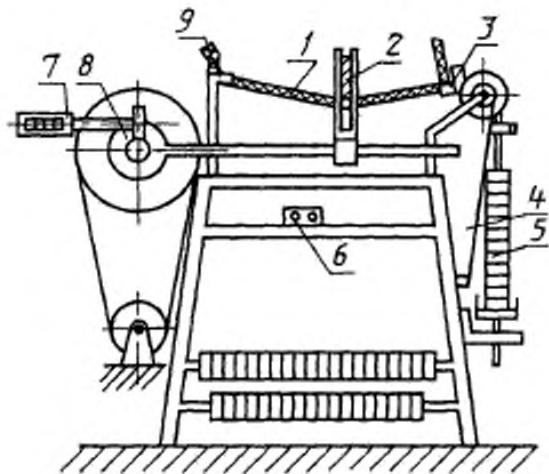
2.4. В качестве абразива используют шлифовальные бруски из электрокорунда марки 24А6ПСМ2К9 квадратного сечения размером 10×10 мм по ГОСТ 2456.
