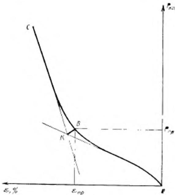
Растяжение пробы проводят до тех пор, пока участок  $BC$  кривой  $OBC$  не перейдет в прямую линию. После этого растяжение прекращают и активный захват возвращают в исходное положение. При обратном ходе активного захвата запись диаграммы не проводят.
