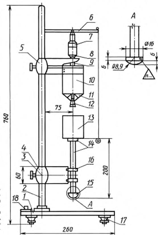
1 — основание; 2 — штатив; 3 — ось; 4 — подвижный кронштейн; 5 — неподвижный кронштейн; 6 — рычаг; 7 — колпачок; 8 — направляющая; 10 — грузовой стакан с отверстием в коническом дне; 11 — запорный шток; 12 — пробка; 13 — подвижная система; 14 — стакан для приемки песка; 15 — шток с плоскадкой; 16 — грибовидная насадка, изготовленная из антикоррозионного материала с подированный шаровой поверхностью; 17 — ролики; 18 — регулировочные ножки; 19 — уровень
