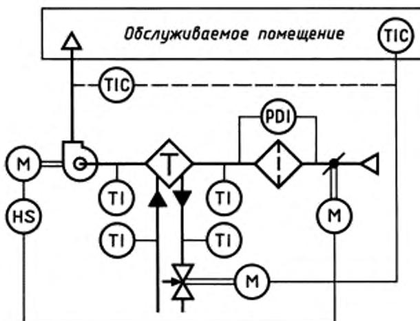
Примечание — Буквенные обозначения измеряемых величин и функциональных признаков приборов, указанные на схеме и в таблице, приняты по ГОСТ 21.404.
