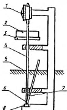
1 — измерительное устройство; 2 — груз; 3 — пластина для груза; 4 — стержень с индентором; 5 — уровень теплопередающей среды; 6 — индентор; 7 — средство для измерения температуры; 8 — испытуемый образец
