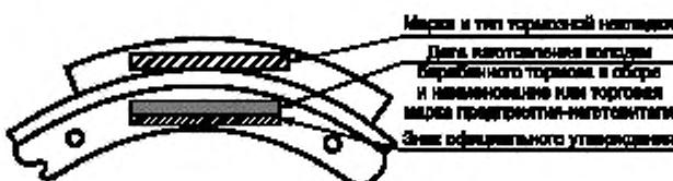
Пример маркировки тормозной накладки барабанного тормоза
