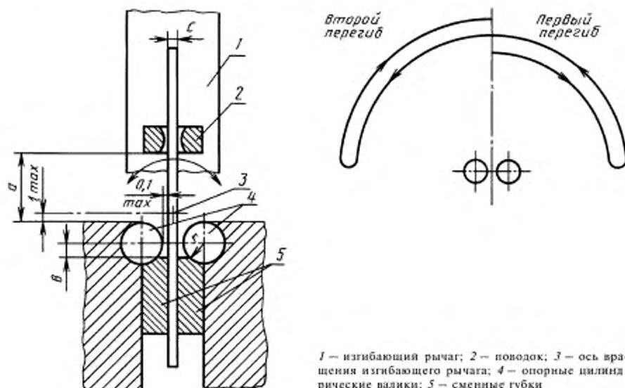
1 — изгибающий рычаг; 2 — поводок; 3 — ось вращения изгибающего рычага; 4 — опорные цилиндрические валики; 5 — сменные губки
