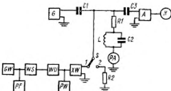
GW—генератор СВЧ мощности; PF—частотометр; WS—ферритовый вентиль; G—генератор переменного тока; WD—переменный аттенюатор; PW—измеритель мощности; XW—измерительная диодная камера; R2—калибровочный резистор; C1, C3—разделительные конденсаторы; R1—добавочный резистор; L, C2—резонансный контур; A—усилитель переменного тока; H—измерительный прибор; PA—амперметр; S—переключатель.
