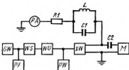
*GW*—генератор СВЧ мощности; *PF*—частотометр; *WS*—ферритовый вентиль; *WU*—переменный аттенюатор; *RI*—добавочный резистор; *PW*—измеритель мощности; *WX*—измерительная диодная камера; *L*, *C1*—резонансный контур; *C2*—разделительный конденсатор; *M*—место переменного тока; *PA*—милливольтметр
