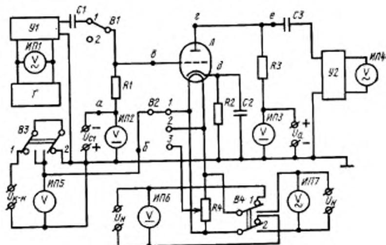
$G$  — генератор;  $ИП1, ИП4, ИП7$  — вольтметры переменного тока;  $ИП2, ИП3, ИП6$  — вольтметры постоянного тока;  $ИП5$  — вольтметр,  $У1$  — делитель напряжения;  $У2$  — фильтр;  $C1, C2, C3$  — конденсаторы;  $R1-R4$  — резисторы;  $B1-B4$  — переключатели;  $a, b, v, e, d$  — вспомогательные обозначения точек схемы;  $L$  — испытываемая лампа.
