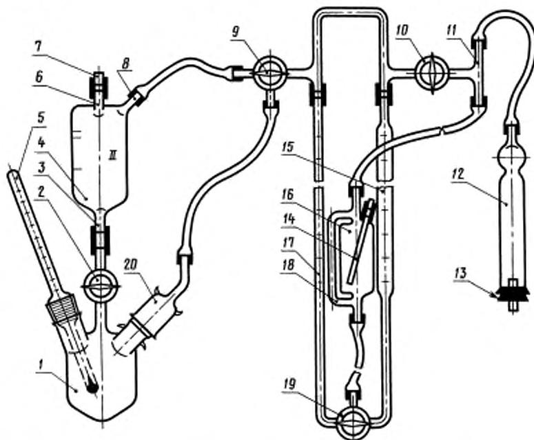
1 — сосуд I; 2, 10 — одноходовые краны; 3, 8 — отводы; 4 — сосуд II; 5 — термометр; 6 — трубка для ввода масла; 7 — заглушка; 9, 19 — трехходовые краны; 11 — трайник; 12 — осушитель; 13 — пробка с отверстием и стеклянной трубкой; 14 — трубка для залива масла; 15, 17 — бюретки; 16 — уравнительная склянка; 18 — сравнительная трубка уравнительной склянки, 20 — крышка
