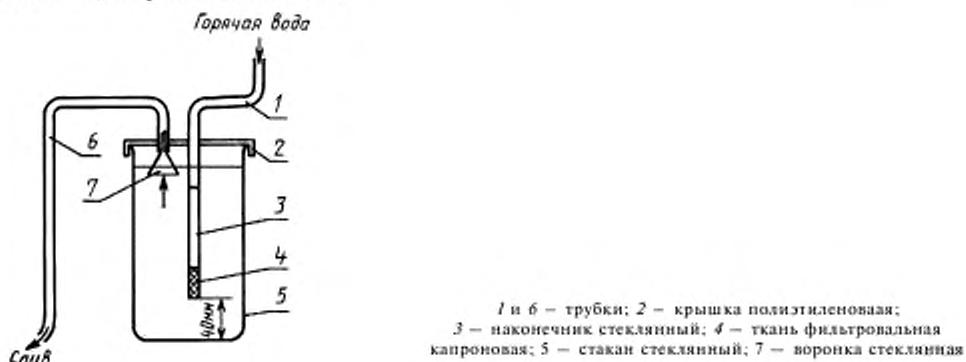
Установка состоит из стеклянного стакана вместимостью 600 см<sup>3</sup> и полизиленовой крышки с двумя резиновыми или полихлорвиниловыми трубками. Первая трубка одним концом присоединяется к водопроводному крану с горячей водой, другим концом — со стеклянным наконечником, конец которого обернут фильтровальной капроновой тканью для улавливания случайных загрязнений, опущена в стакан. На конце другой трубы для слива вставлена воронка.
