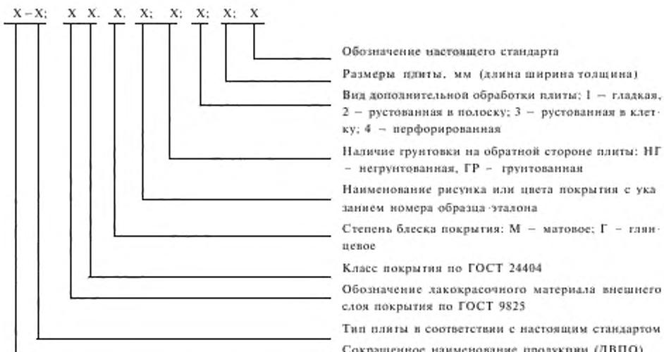
Пример условного обозначения плиты типа Б с лакокрасочным покрытием III класса; с внешним слоем из эмали МЛ-242, глянцевой, белой, образец-эталон № 4; грунтованной с обратной стороны; рустованной в клетку; длиной 2700 мм, шириной 1700 мм, толщиной 3,2 мм:
