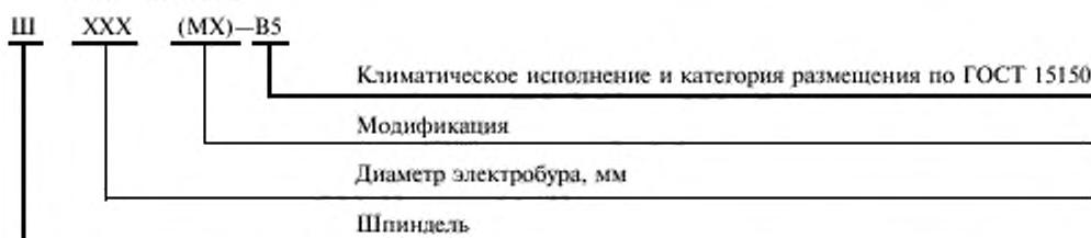
Пример условного обозначения типа шпинделя для электробура диаметром 164 мм, первой модификации, климатического исполнения В, категории размещения 5:
