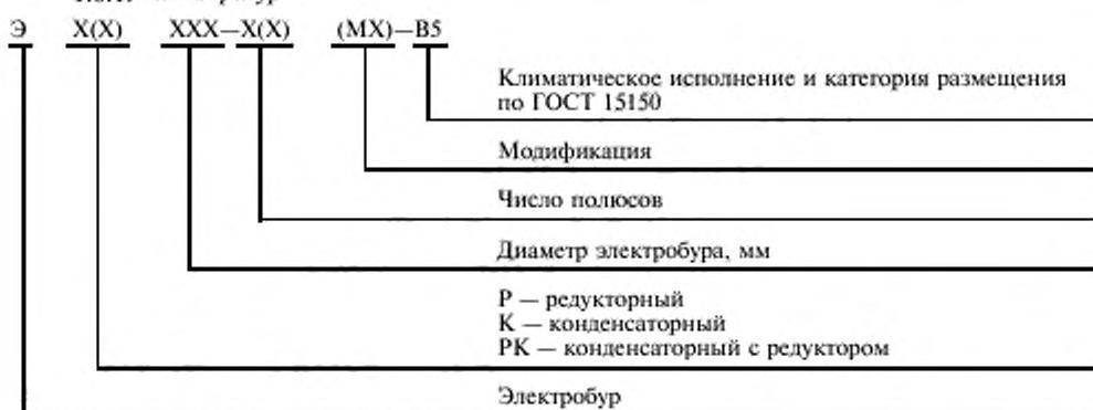
Пример условного обозначения типа электробура редукторного конденсаторного с диаметром электробура 164 мм, числом полюсов 4, климатического исполнения В, категории размещения 5:
