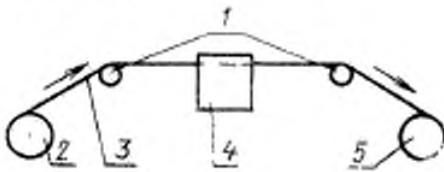
1—направляющие ролики; 2—отдающее устройство; 3—испытываемый провод; 4—датчик с электролитом; 5—приемное устройство
