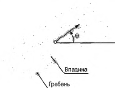
Рисунок 4 — Расположение контрольной точки окончания основы гребней
