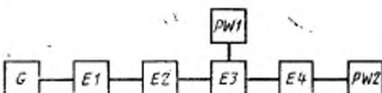
*G* — генератор СВЧ мощности; *E1* — вентиль; *E2* — переменный аттенюатор; *E3* — ответвитель; *E4* — диодная камера с ограничительным диодом; *PW1*, *PW2* — измерители мощности
