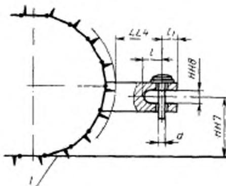
$I$  — опорная плоскость отсчета;  $L_{1A}$  — расстояние от контура гусеницы до оси отверстия под палец;  $l$  — расстояние от оси отверстия под палец до перемычки вилки;  $l_1$  — расстояние от оси отверстия под палец до конца вилки;  $d$  — диаметр вилки;  $HN7$  — расстояние от опорной поверхности до горизонтальной плоскости симметрии вилки;  $HN8$  — ширина паза вилки.
