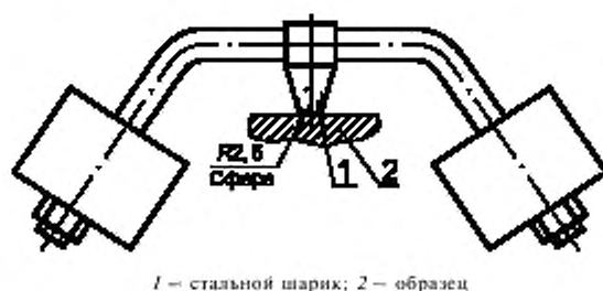
Рисунок 12 — Устройство для испытания давлением шарика
