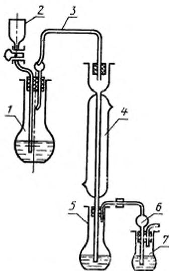
1 — перегонная колба; 2 — капельная воронка; 3 — трубка с гидрозатвором; 4 — холодильник; 5 — пробирник; 6 — гидрозатвор; 7 — контрольный приемник
