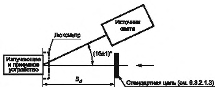
Рисунок 11с — Датчик типа D, излучающее и приемное устройство и стандартная цель
