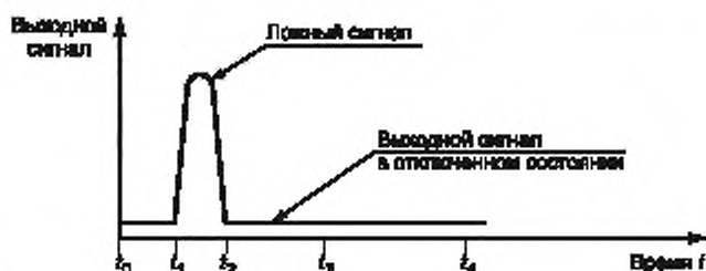
Рисунок 7б — Коммутационный элемент в выключенном состоянии
