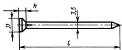
$D_{\min} = 8 \text{ мм}; h_{\min} = 0,6d$
