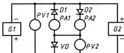
*G1, G2 — регулируемые источники обратного напряжения и прямого тока; PV1 — измеритель обратного напряжения, под-
