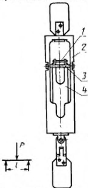
Нижняя деталь состоит из круглого стержня с двумя стойками 4, между которыми укреплен изгибающий валик 1. Изгибающий валик, также как и опорные, свободно вращается вокруг своей оси.
