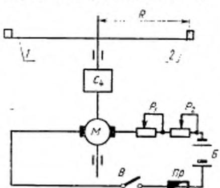
1—крестовина; 2—стойка для крепления анемометров; С4—счетчик частоты вращения крестовины; М—двигатель; Р<sub>1</sub>, Р<sub>2</sub>—реостаты; Б—аккумуляторная батарея; В—выключатель; Пр—предохранитель.
