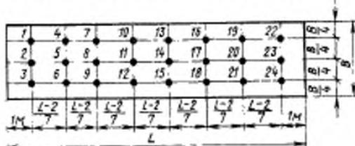
4.2. Отобранные точечные пробы каолина объединяют в объединенную пробу, измельчают до крупности менее 5 мм, тщательно перемешивают и методом квартования сокращают до средней пробы массой не менее 1,5 кг.
