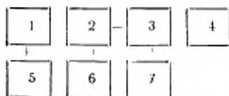
1 — развязывающее устройство с КСВН не более 1,25; 2 — поверяемая измерительная линия; 3 — вспомогательная измерительная линия; 4 — согласующая нагрузка; 5 — генератор сигналов; 6, 7 — индикаторные приборы
