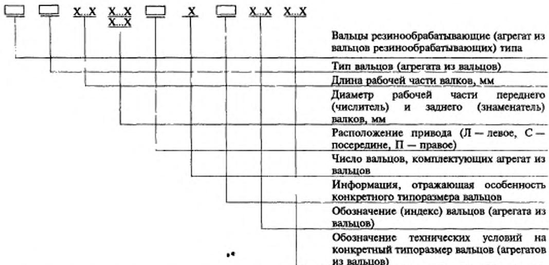
Пример наименования для написания в технической документации резинообрабатывающих валцов типа Пд с длиной рабочей части валков 2100 мм, диаметрами рабочей части переднего и заднего валков 660 мм, с левым расположением привода:
