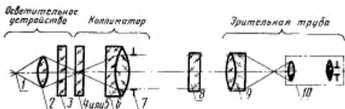
1—источник света; 2—конденсор; 3—сменный фильтр или матовое стекло; 4—набор штриховых мир; 5—набор точечных диафрагм (4, 5—сменные); 6—объектив коллиматора; 7—диафрагма коллиматора; 8—образец стекла; 9—объектив зрительной трубы; 10—микроскоп
