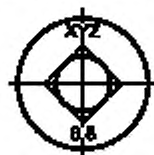
Рисунок 9 — Пример маркировки болтов с полукруглой головкой и квадратным подголовком
