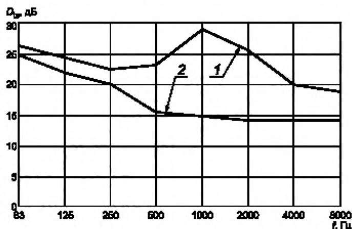
Рисунок А.2 — Зависимость потерь при прохождении D_{15} от частоты f для перекрестного глушителя (гибкий трубчатый глушитель длиной 500 мм, толщина звукопоглощающего покрытия 25 мм) с дисковым клапаном номинальной ширины 150 мм
