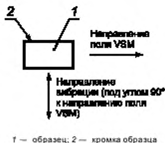
Рисунок 8 — Ориентация образца при измерениях с использованием VSM
