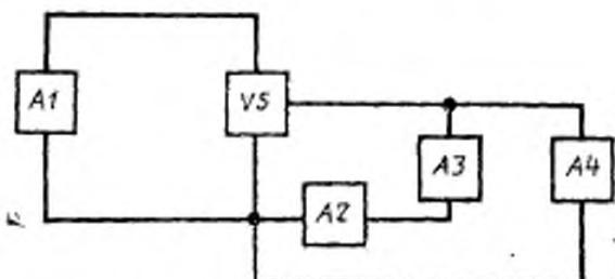
A1—устройство задания режима в цепи основных выключений тиристора; VS—испытуемый тиристор; A2—измерительное устройство для измерения неотпирающегося (постоянного или импульсного) тока управления; A3—устройство задания режима в цепи управления; A4—измерительное устройство для измерения неотпирающегося постоянного или импульсного напряжения управления
