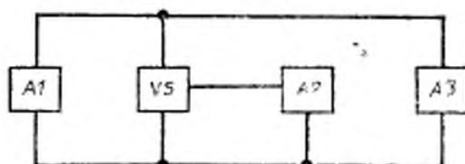
*A1*—устройство задания режима в цепи основных выводов тиристора; *VS*—испытуемый тиристор; *A2*—устройство задания режима в цепи управления (или диодных тиристоров, отсутствует); *A3*—измерительное устройство для измерения критической скорости нарастания напряжения в закрытом состоянии
