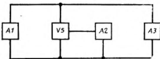
A1—устройство задания режима в цепи основных выводов тиристора; VS—испытуемый тиристор;
