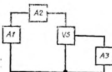
*A1—устройство задания электрического режима в цепи основных выводов тиристора; VS—испытуемый тиристор; A2—измерительное устройство для измерения тока удержания или тока включения; A3—устройство задания электрического режима в цепи управления (для диодных тиристоров отсутствует)*
