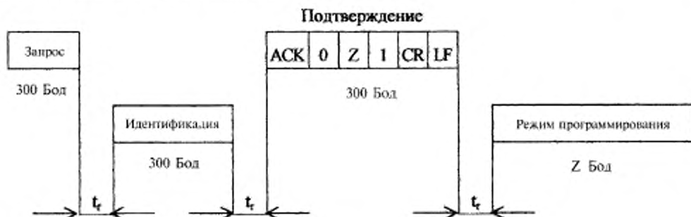
Протокол передачи для режима С. Переключение в режим программирования с принятием предложенной скорости передачи информации
