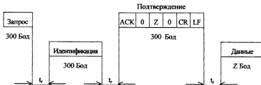
Протокол передачи для режима С, позволяющий считывание данных с подтверждением предложенной скорости передачи информации
