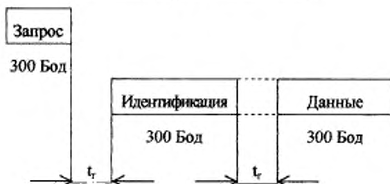
Протокол передачи для режима С, позволяющий считывание данных без подтверждения от ПСУ
