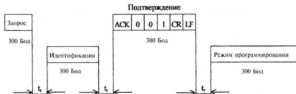
Протокол передачи для режима С. Переключение в режим программирования с отклонением предложенной скорости передачи информации
