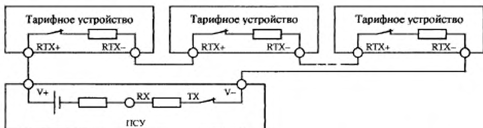
Рисунок 1б — Схема двухпроводной линии с несколькими исполнителями
