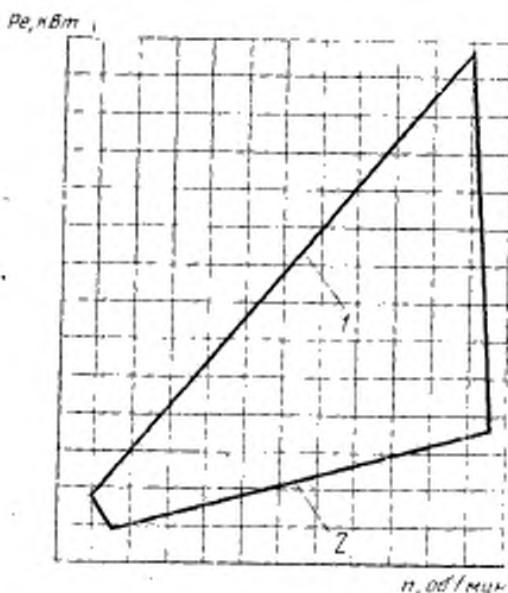
1 — верхняя ограничительная характеристика — характеристика наибольших мощностей, допустимых при длительной работе дизеля; 2 — нижняя ограничительная характеристика — характеристика минимальных мощностей, допустимых при длительной работе дизеля
