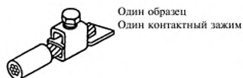
Рисунок F.4 — Торцевой зажим
