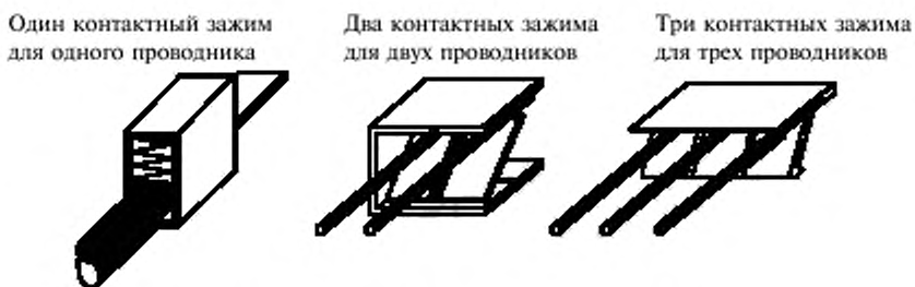
Рисунок F.6 — Примеры безвинтовых контактных зажимов
