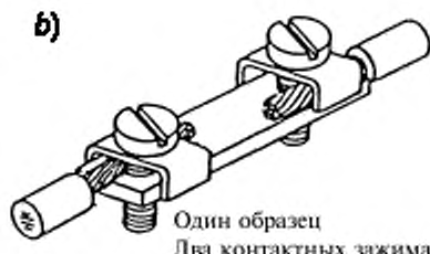
Один образец Два контактных зажима
