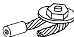
Рисунок F.2 — Косвенный зажим с помощью промежуточной детали неподготовленных проводников
