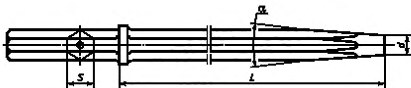
Рисунок 1 — Буровые штанги с конусом
