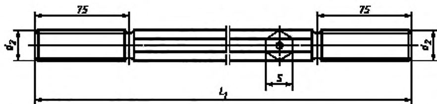
Рисунок 5 — Буровые и удлинительные штанги с резьбой
