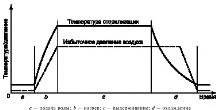
Рисунок В.4 — Пример цикла стерилизации с распылением воды
