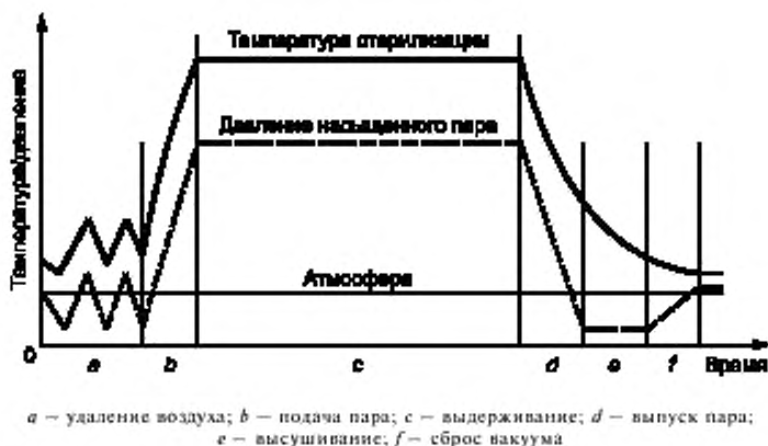
Рисунок В.2 — Пример цикла стерилизации насыщенным паром с принудительным удалением воздуха
