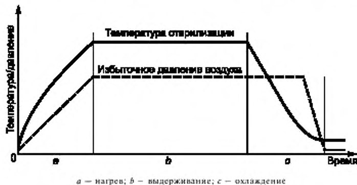
Рисунок В.3 — Пример цикла стерилизации паровоздушной смесью
