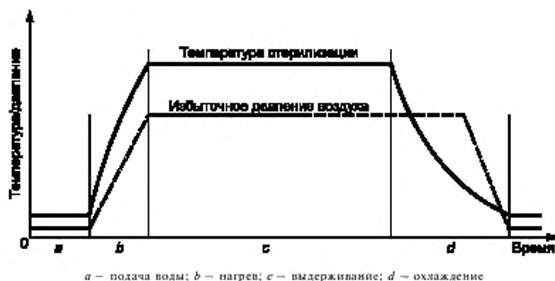
Рисунок В.5 — Пример цикла стерилизации погружением в воду
