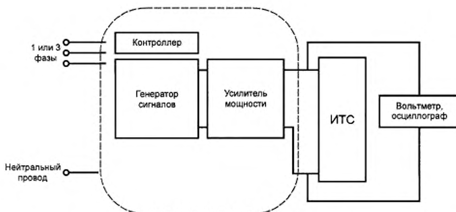
Рисунок 3 — Схема испытательного оборудования с усилителем мощности
