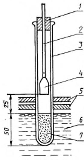
1—пробка; 2—стеклянная трубка; 3—пробирка; 4—издикторная бумага «конго» красный; 5—крышка; 6—масляная баня; 7—образец
